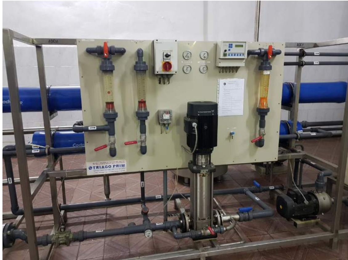
Stand pentru determinarea caracteristicilor hidraulice ale pompelor
